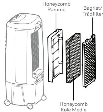
**ADVARSEL:** BETJEN IKKE Air Cooler når bagristen er fjernet fra Luftkøleren, eller hvis der er en løstsiddende Bagrist. Det kan medføre alvorlig personskade eller farlig elektrisk stød.
