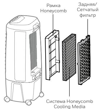
**ВНИМАНИЕ:** Во избежание травмы или удара током не включайте установку со снятой задней решеткой корпуса установки или с ослабленными винтами крепления задней решетки.
